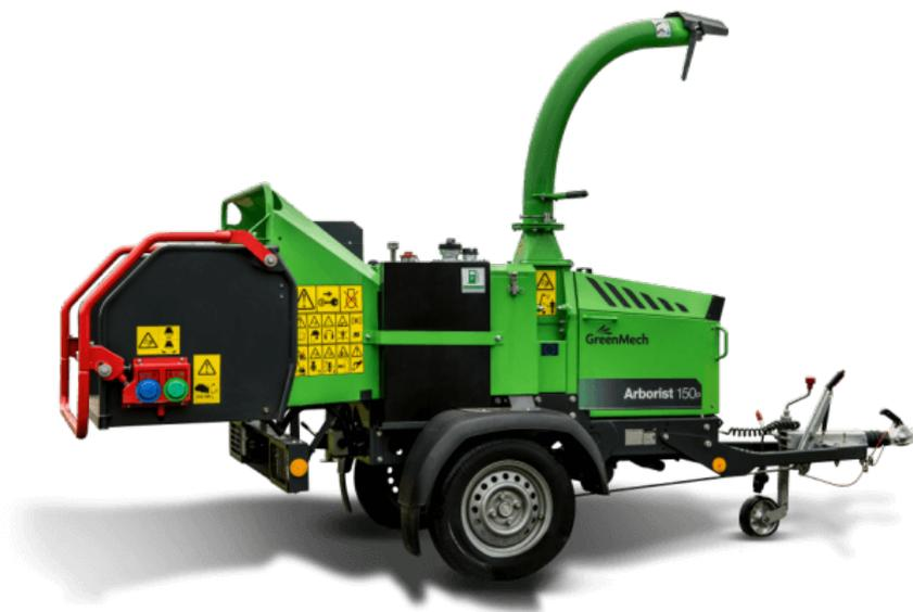
безостановочную переработку для обеспечения впечатляющей пропускной способности с материалами до 150 мм. Как и все рубильные машины GreenMech, Arborist 150p спроектирован с такой же проверенной и надежной конструкцией шасси. Шумоизолированные стальные панели обеспечивают отличное шумоподавление, и панели легко снимаются, что обеспечивает хороший доступ для текущего обслуживания.
