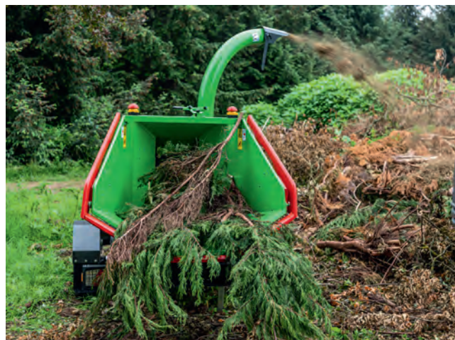
Массивный подающий стол на компактном шасси
